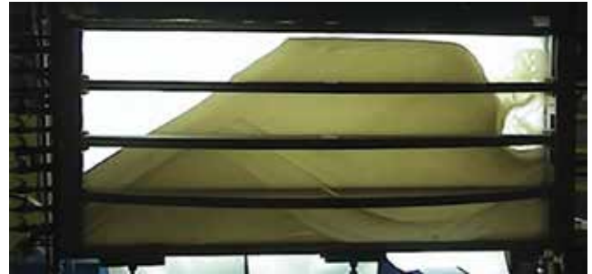
Hình 4. Hạt chèn bao phủ toàn khe nứt trước khi đóng (nguồn: Stim-lab, 1994)
